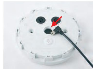
Zentralen Stopfen entfernen und USB-Kabel hindurchführen
