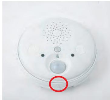
ExtIO-Gehäuse schließen Pfeilmarkierungen ausrichten
