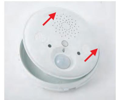
Bodenteil und Gehäuse trennen
