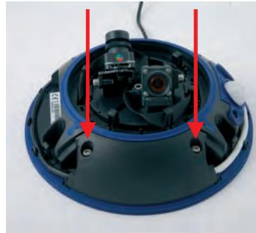
Montieren Sie stets die Kabelabdeckung (IP65)!
