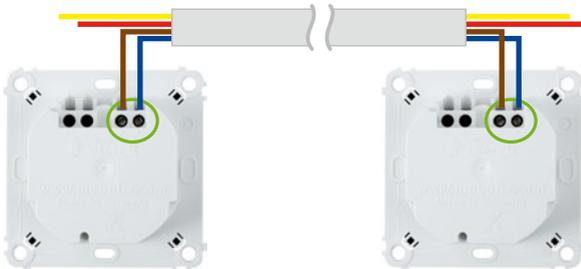
Vor der Montage der beiden Mx2wire-Einheiten sollte die einwandfreie Funktion der Kabelverbindung sichergestellt sein (evtl. Messprotokoll anfertigen). Für weitere Entfernungen eignen sich Koaxkabel und Ethernetkabel (Cat-7) bauartbedingt am besten.
