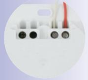
5. **Gehäuse mit Platine in Aufputzdose einsetzen:** Die beiden Kabelklemmen an der Rückseite des Gehäuses befinden sich oben. Das Gehäuse mit Platine wird über die vier vorgebohrten Löcher mit vier Edelstahlsschrauben (Pos. 1.4) an der Aufputzdose befestigt.
