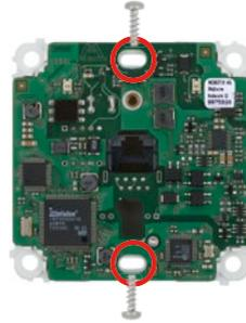
Befestigung der Platine mit zwei Schrauben (Pos. 1.4.) direkt an der Dose (siehe links) oder alternativ mit den Torx-Schrauben an der Wand (siehe Seite 22)
