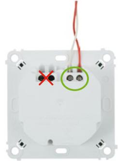
3. **Mx2wire-Frontblende und Rahmen abheben:** Zum Schutz der Mx2wire-Platine ist diese in der Originalverpackung noch mit Frontblende und Rahmen verbunden. Für die weitere Montage wird das Gehäuse mit Platine (Pos. 1.1) jedoch separat benötigt. Lösen Sie die Schraube der Frontblende (Pos.1.2) und heben Sie diese nach vorne ab.
