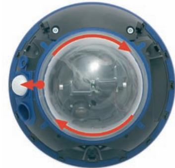
Domkuppel mit der **Markierung** in Richtung PIR aufsetzen
