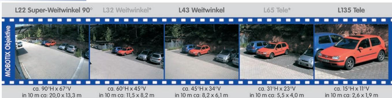
Das **L22 Super-Weitwinkel 90°** hat eine sehr geringe Verzeichnung und liefert auch im maximalen Digital-Zoom noch gute Bildqualität. Wird die Kamera mit diesem Objektiv in einer Raumecke montiert, kann der ganze Raum eingesehen werden.
