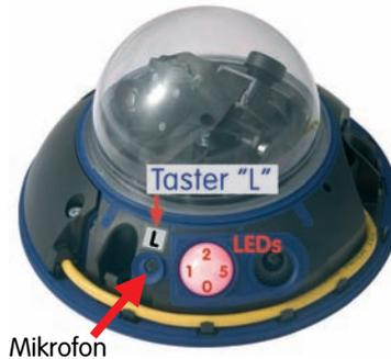
**Die Kamera ist jetzt wieder über die werkseitige IP-Adresse erreichbar (siehe Typenschild am Kameragehäuse).**
