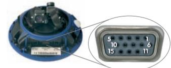
Die Signalleitungen der seriellen Schnittstelle können zusätzlich als Signaleingänge genutzt werden: **Setup-Menu > Ereigniseinstellungen > Signaleingang CTS, RxD**. Damit stehen drei getrennte Signaleingänge zur Verfügung
