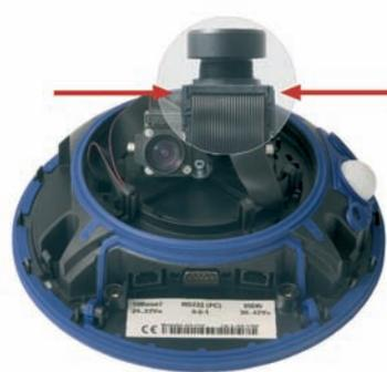
**(7) Lösen und Entfernen der zentralen Objektivfeststellschraube, Entnahme der Objektivseinheiten**
