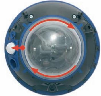
**Wichtig:** Setzen Sie die Domkuppel mit der Markierung in Richtung des PIR-Sensors auf die Kamera auf. Dies verhindert ein Verkanten der Domkuppel!
