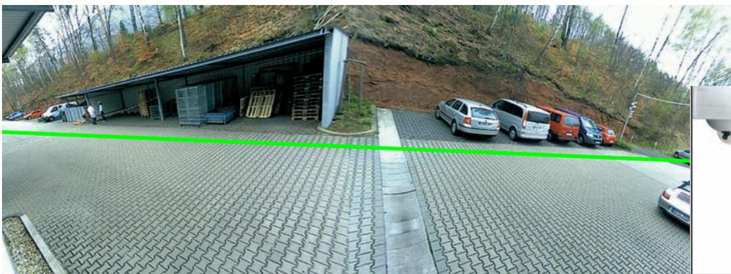
Optimale Ausrichtung der D12D-180°: Ebene Fläche wird korrekt dargestellt
