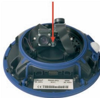
**Achtung:** Ziehen Sie die Halteschraube nicht mit übermäßiger Kraft an, da dies das Gehäuse beschädigen könnte.
