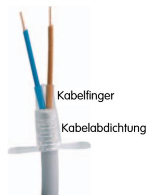
Nach VDE-Vorschrift darf keine Feuchtigkeit in den Kabelmantel bzw. zwischen den Kabelmantel und die Adern eindringen, da dies zur Korrosion der Kabel führen könnte. Das Aufbringen der Silikonpaste in Verbindung mit den Kabelabdichtungen verhindert dies zuverlässig.
