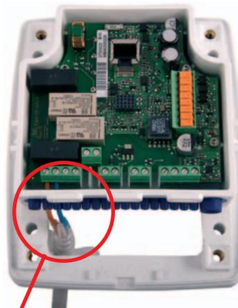
Wurde die blaue Abdichtung an der falschen Stelle durchstoßen, muss das Gehäuse zur Einhaltung der Schutzklasse IP65 ausgewechselt werden!
