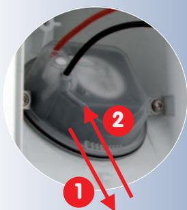
**2.6.2 Anschließen des Ethernet- und des CamIO-Steuerungskabels**
