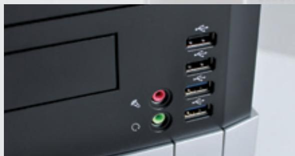
USB 3.0 und USB 2.0, sowie Audio-Schnittstellen in der Front integriert
