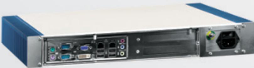
Der Fanless Medical 1000 kann mit einem Intel® Core i3 / i5 / i7 Prozessor ausgestattet werden. Zusätzlich kann in der Front ein CardReader integriert werden.
